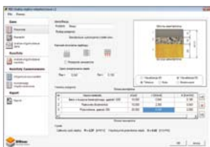
REX Analiza Ciepłno-wilgotnościowa - Przegroda
